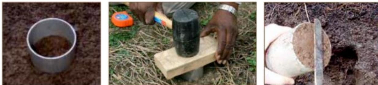
Figura 7. Muestreo de densidad aparente con el método del cilindro.
